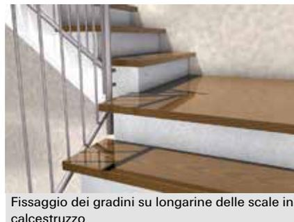
Fissaggio dei gradini su longarine delle scale in calcestruzzo
